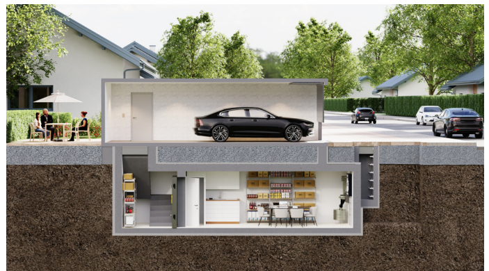
Als Fundament für Garage mit Treppenmodul
