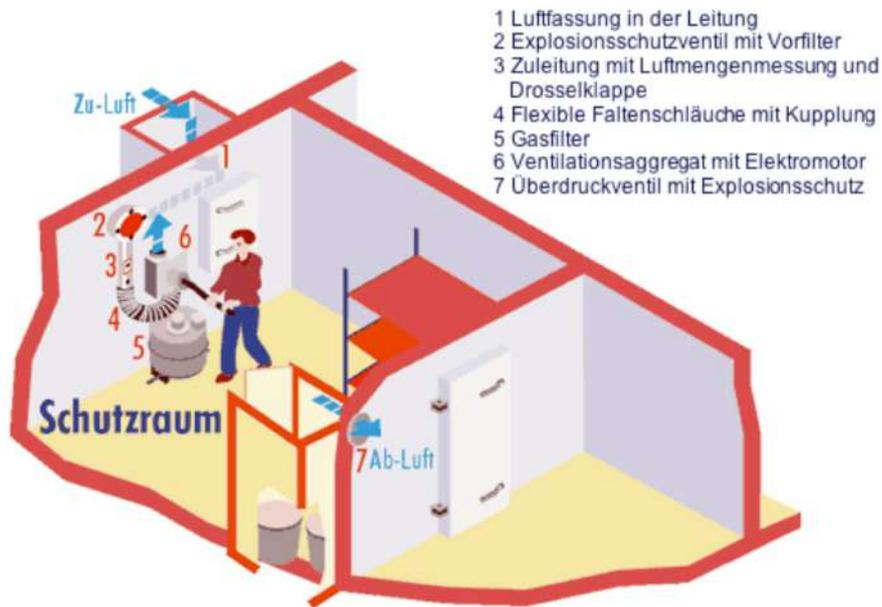
Die Mengeu-Belüftungsanlagen VA 40/75/150 und VA 300 dienen der Versorgung der Schutzraumsinsassen mit gereinigter Aussenluft sowie der Abfuhr der verbrauchten Luft.
